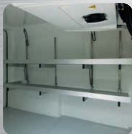
Plancher antidérapant avec passage de roues et étagères relevables (en option)
