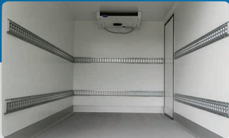
Niveaux de rails d'arrimage. Compatibles avec sangles à rail large – Sangles à crochets – Etais – Bloc Roll
