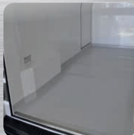
Plancher antidérapant avec caissons de passages de roues
