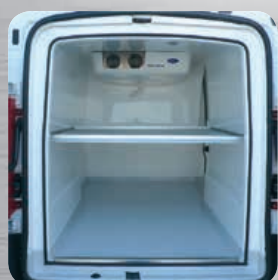
Plancher antidérapant avec passage de roues et plancher intermédiaire
