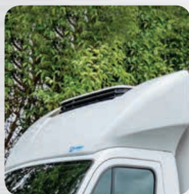
Déflecteur aérodynamique avec découpe tridimensionnelle pour groupe
