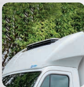
Déflecteur aérodynamique avec découpe tridimensionnelle pour groupe
